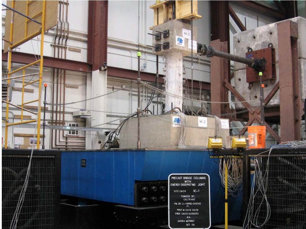
Fig. 2-11. Shake Table Test Set Up
