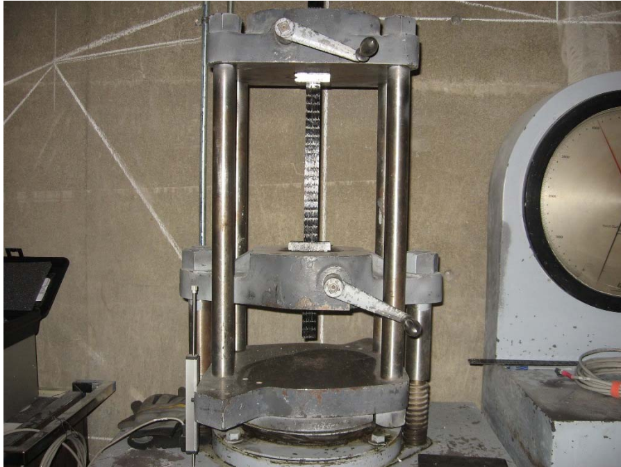
Fig. 2-7. FRP Coupon Testing
